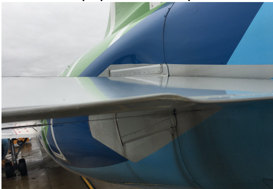
Hình 1: Hình ảnh hỏng hóc mép sau cánh lái độ cao tàu bay VN-A222
