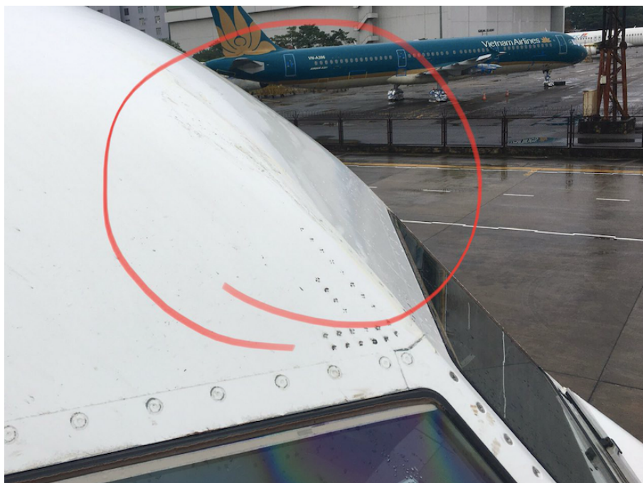
Hình 3: Hình ảnh hỏng hóc tại phần vỏ bên trên buồng lái tàu bay VN-A590
