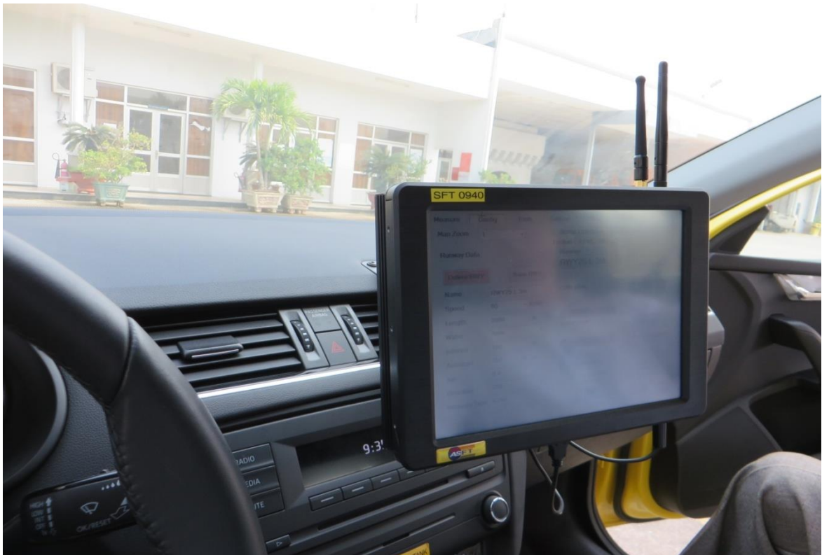
Hình H-3 - Màn hình thiết bị đo ma sát của xe ASFT của CHKQT Tân Sơn Nhất
