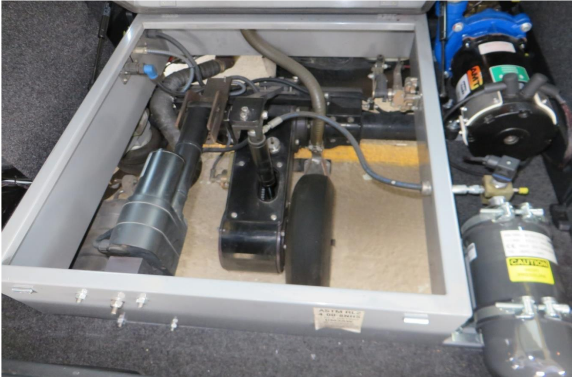
Hình H-2 - Bánh xe đo ma sát của xe ASFT của CHKQT Tân Sơn Nhất
